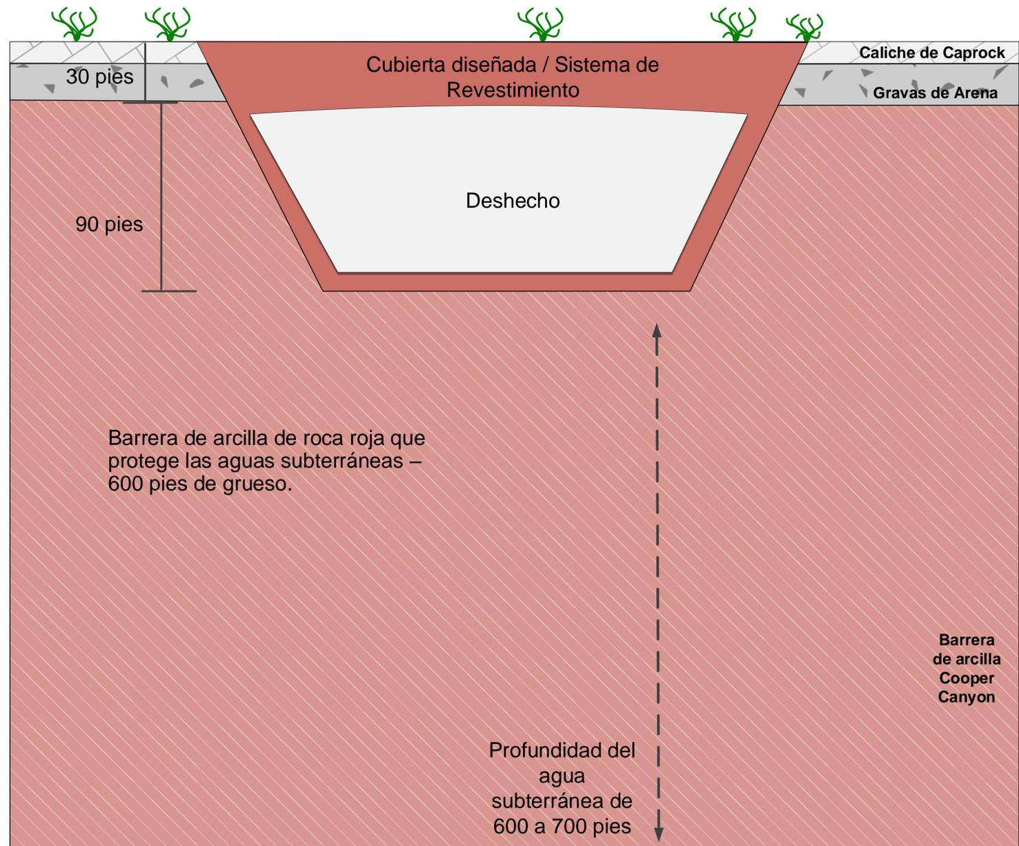
Diseño de Subgrado: se evita la erosión
